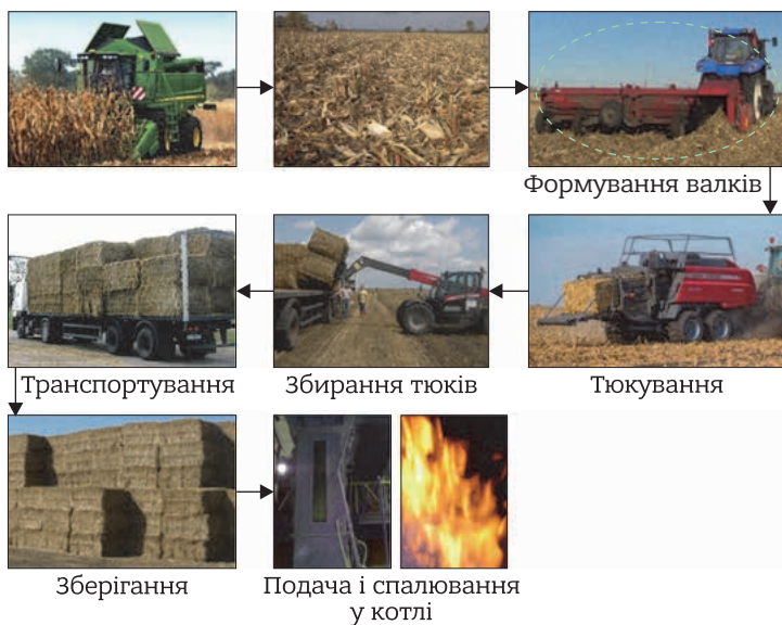
Рис. 4.5. Схема організації виробничого процесу заготівлі та використання кукурудзиння
