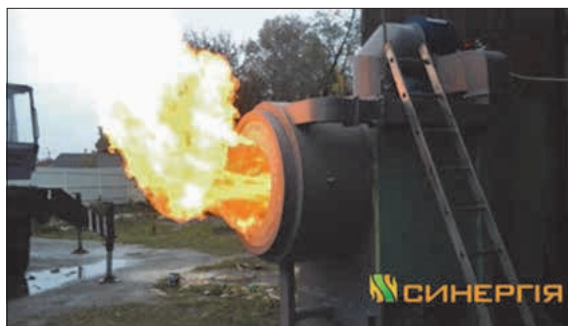
Рис. 11.26. Циклонний принцип спалювання сипких палив
