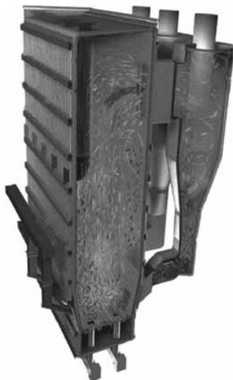
Рис. 7.21. Котел з ЦКШ
