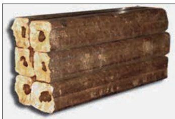
Брикетти з деревини типу Pini Kay (так звані «євродрова»), екструдерне пресування
